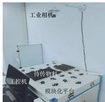
图13 模块化传输平台实验样机
